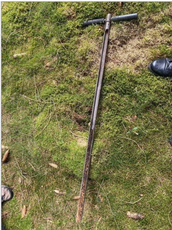
Abbildung 5 Fotos der Ortsbegehung und Untersuchung der oberen Bodenschichten mittels Pürckhauer
